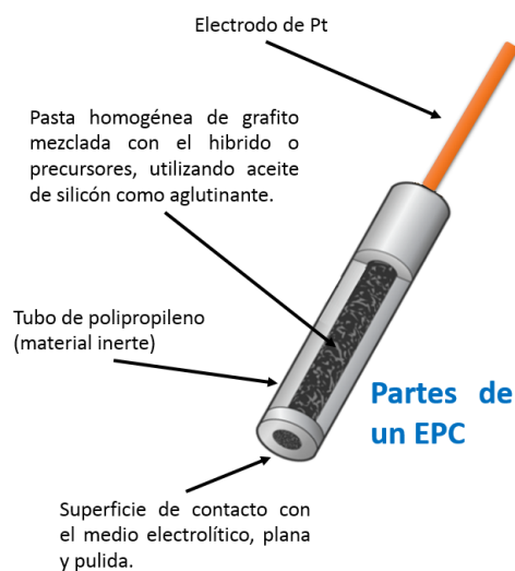
Figura 1. Partes de un Electrodo de Pasta de Carbono.
