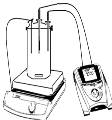
Figura 1. Esquema del equipo empleado en el estudio de descomposición de la jarosita de talio en medio CaO (pH 12.25, 30 °C, 650 rpm).
