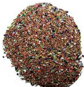
Figura 1. Polvo de cobre generado por la molienda de placas de circuitos impresos de computadoras.
