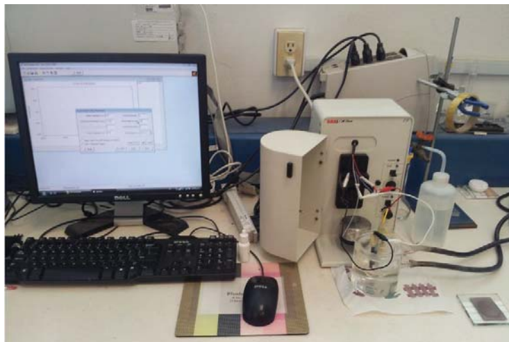
Figura 1. Imagen del potenciostato EPSILON conectado al ordenador personal que ejecuta el software de BASI EPSILON EC, junto con la celda electroquímica utilizada durante los experimentos.
