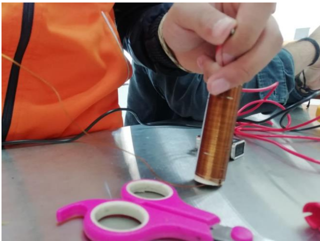
Fig. 2.- Enrollar el alambre magneto en el tubo PVC.
