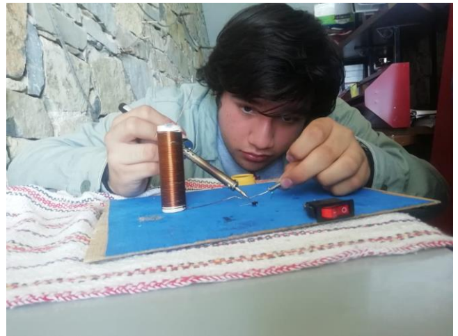
Fig. 3.- Soldar la punta inferior de la bobina creada con el colector del transistor.
