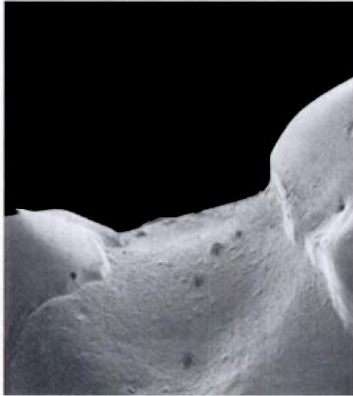
Fotografía al MEB de una resina compuesta de microrelleno con nueve años de uso.
