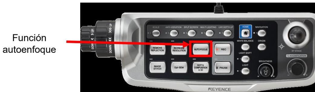
Figura 5 Botón de función de autoenfoco de la consola
