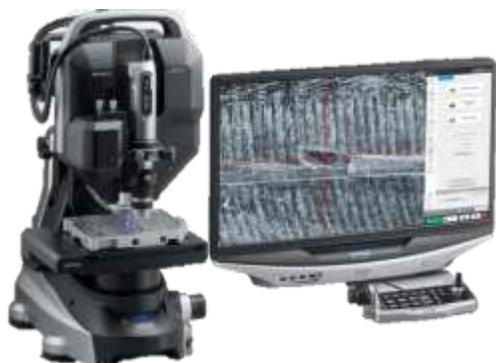
Observa e identifica instantáneamente los materiales sin la necesidad de destrucción, deposición ni vacío, se basa en el principio de detección de espectroscopía de ruptura inducida por láser.
