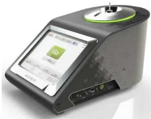
Mide la estructura de compuestos orgánicos y organometálicos, posibilita la determinación de la estequiometría del esqueleto carbonado y proporciona información valiosa de otros núcleos magnéticamente activos.
