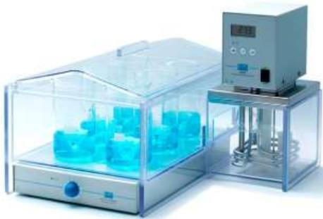
Determina la fibra dietética total. Utiliza enzimas termoestables y opera con el método oficial de la AOAC, agita de manera continua y constante la muestra. Aplicación en alimentos y bebidas.
