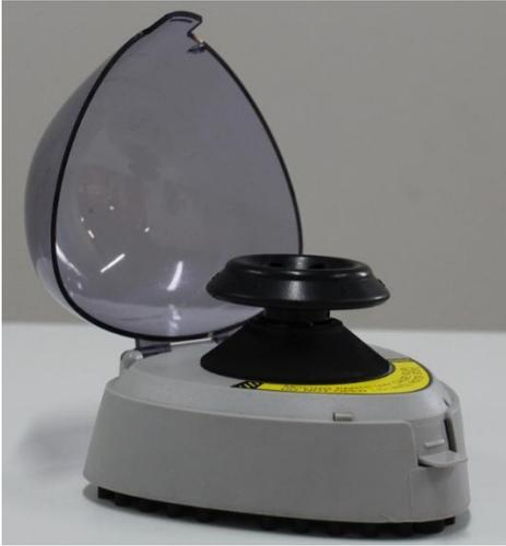
Útil en la separación de fases líquidas y sólidas de muestras complejas, en la extracción de material genético y otras moléculas, así como en la concentración de sustancias presentes en una muestra. Rango máximo de 7200 rpm. Capacidad para 8 microtubos de 0.5, 1.5 y 2.0 mL.
