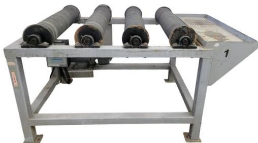
Equipo para pruebas de molienda o lixiviación de minerales, consta de 4 rodillos de 5" de diámetro, capacidad de procesamiento de 8 pruebas de manera simultánea, rango de velocidad de 40 a 230 RPM.
