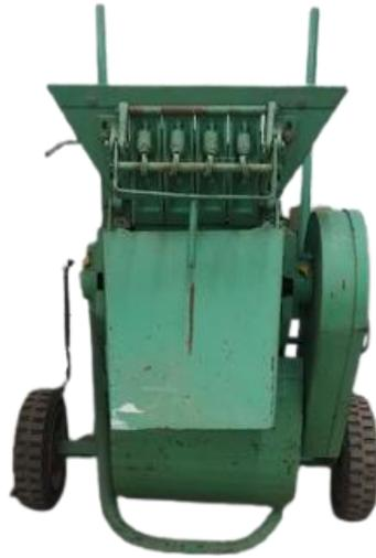
Sistema mecánico para eliminar los terrones de la arena por atricciónamiento, para su posterior cribado y reutilización.
