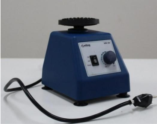
Cuerpo robusto y con control de velocidad variable. Incluye plataforma de 7.5 cm de diámetro y copa para tubos. Rango de velocidad: 600 a 3200 rpm. Movimiento Orbital. Interruptor de alimentación de 3 posiciones para funcionamiento continuo, intermitente o al tacto.
