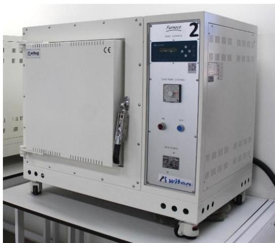
Equipo ideal para determinación de cenizas, esmaltado, secado y/o fusión de sólidos. Capacidad de 11 L. Rango de temperatura de 300 °C hasta 1200. Cuenta con temporizador de funcionamiento.
