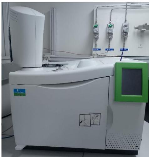
Realiza análisis de aceites, grasas, solventes, compuestos orgánicos de la industria alimenticia y cosmética. Equipado con un detector de ionización de llama de amplio alcance (FID), y tecnología de automuestreador.
