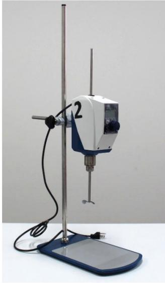
Útil para aplicaciones de alta velocidad en medios de poca viscosidad. Controlador digital. Rango de velocidad de 500 a 2000 rpm.
