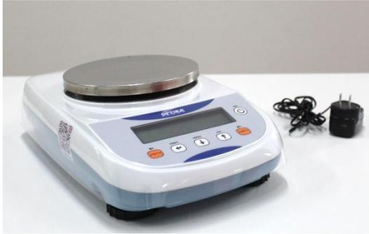
Instrumento para medir la masa de objetos o sustancias. Permite la medición de hasta 4200 g, con una resolución de 0.01 g. Cuenta con indicador de estabilidad.
