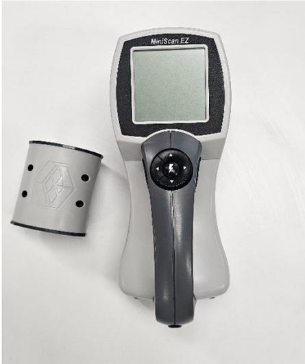
Muestra datos de color, diferencias de color, gráficos de color, datos espectrales, gráfico espectral, gráfico de diferencias espectrales. Aplicaciones en alimentos, plásticos, materiales de construcción sólidos, pintura y textiles.
