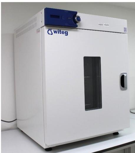
Equipo ideal para secar, tratar, precalentar, cocinar y/o degradar sustancias. Capacidad de 155 L. Rango de temperatura: 25 hasta 250 °C. Cuenta con temporizador de funcionamiento y con protección de sobrecalentamiento.
