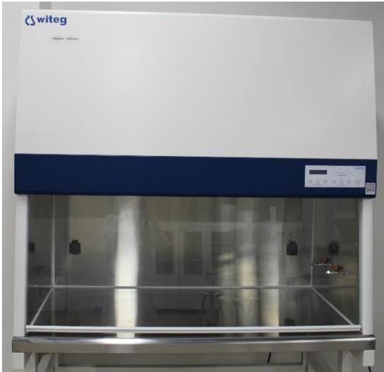
Permite operaciones que requieren condiciones asépticas. Flujo de aire vertical, con control de velocidad de aire de 8 velocidades. Filtro HEPA Clase 100 con válvula de aire y gas doble UV (30W) y Fluorescente (56W), con control digital por microprocesador y retroiluminación LCD.
