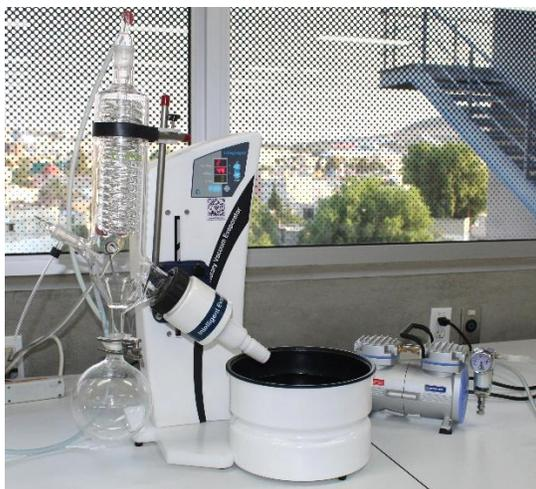
Equipo ideal en todas las aplicaciones de destilación con alta presión de vacío. Cuenta con pantalla digital para el control manual de la elevación, velocidad de rotación (20 – 280 rpm) y temperatura del baño de agua (hasta 180°C). Para evaporar en matraz balón con junta 29/42.
