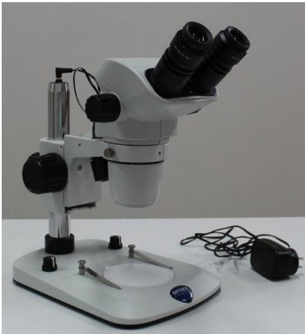
Instrumento que dispone de dos oculares para la observación en 3D. Es útil para realizar trabajos de montaje o de remontaje de especímenes biológicos.
