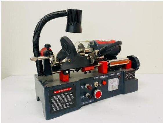
Herramienta tipo torno diseñada para la reproducción de llaves tipo: planas tetra y radiales. Velocidad de rotación: 2,900 rpm. Ciclo de trabajo: 50 minutos de trabajo por 20 minutos de descanso. Dureza de cortadores: 66 HRc. Horario de atención: 9:00-17:00 h.
