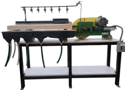
Separación de minerales metálicos y minerales no metálicos que presenten una diferencia de peso específico de sus componentes mayor a 1.25, y con tamaño de partícula de malla 20 a malla 200, capacidad de procesamiento de 20 kg/h.
