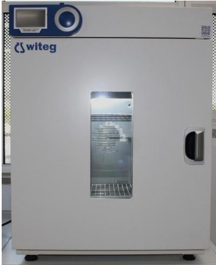
Útil para el secado de materiales, deshidratación de sustancias sensibles al cambio brusco de temperatura o que podrían dañarse con altas temperaturas.
