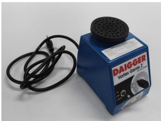
Cuerpo robusto y con control de velocidad variable. Incluye plataforma de 7.5 cm de diámetro y copa para tubos. Rango de velocidad: 600 a 3200 rpm. Movimiento Orbital. Interruptor de alimentación de 3 posiciones para funcionamiento continuo e intermitente o al tacto.
