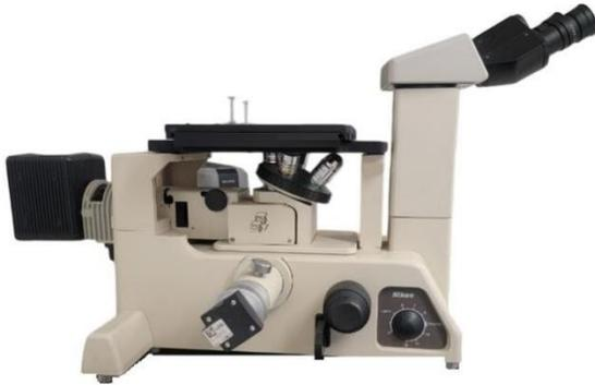
Análisis microestructural de muestras metalográficas. Permite la captura y análisis de imágenes.
