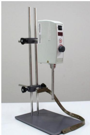
Útil para realizar dispersiones, suspensiones, emulsiones, disolución de sólidos, preparación de muestras, descomposición de células, formulación de cremas y alimentos y para la extracción de principios activos. Rango de velocidad de 500 a 30000 rpm. Capacidad de 0.05 a 2500 mL. Horario de atención: 08:00-20:00 h.
