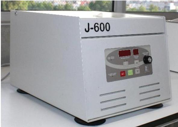
Centrífuga digital de acero inoxidable, ideal para la separación de células, virus, proteínas, suspensiones, preparación de muestras, etc. Velocidad máxima de 3500 rpm, capacidad para 8 tubos de 15 mL. Cuenta con detección de desbalance y temporizador de funcionamiento.
