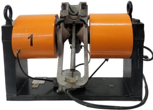
Determina la susceptibilidad magnética de los minerales y realiza la concentración de minerales ferromagnéticos y paramagnéticos. La intensidad de campo es hasta 4000 gauss, 150 volts y 3 amperes.
