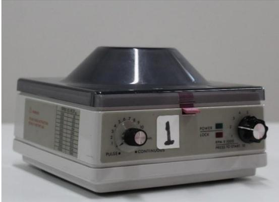
Útil en la separación de fases líquidas y sólidas de muestras complejas, en la extracción de material genético, así como en la concentración de sustancias presentes en una muestra. Rango máximo de 1000 rpm. Temporizador de pulso y continuo de 10 minutos. Capacidad para 6 microtubos de 1.5 mL. Horario de atención: 08:00-20:00 h.
