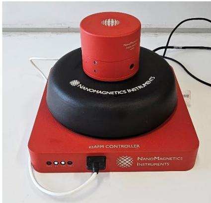
Técnica de medida superficial que se basa en la interacción de una punta afilada situada en el extremo de una placa flexible con la superficie de la muestra.
