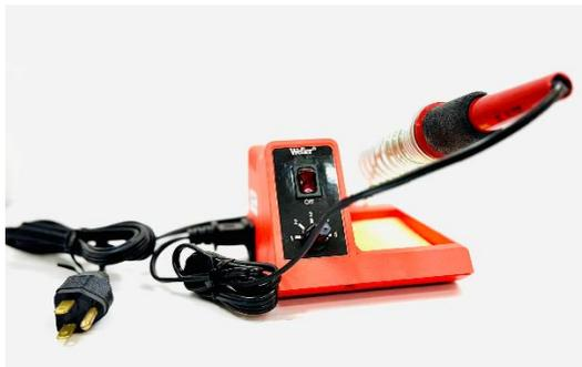
Se utiliza para adherir y/o retirar componentes electrónicos y otros materiales en una tarjeta electrónica. Mediante un dial de control de energía es posible ajustar la potencia de 5 W a 40 W y así alcanzar una temperatura de hasta 482°C.
