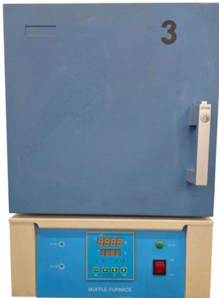
Permite calentar, secar, fundir, incinerar, calcinar, y tratar térmicamente materiales a altas temperaturas.
