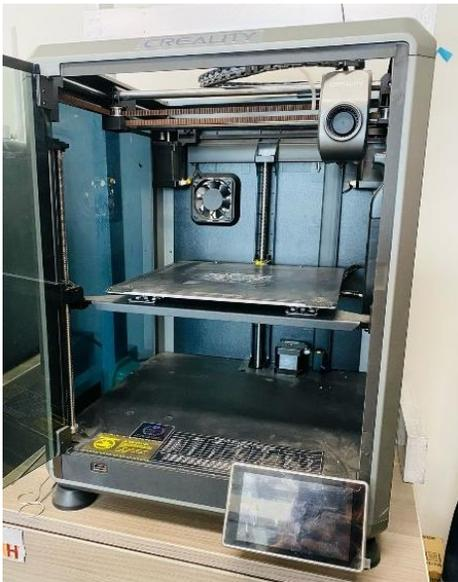
La impresora de alta velocidad y precisión, tecnología de impresión: Modelado por Deposición Fundida. Volumen de construcción: 220 x 220 x 250 mm. Velocidad máxima: 600 mm/s. Precisión:  $\pm 0.1$  mm. Altura de capa: 0.1 – 0.35 mm. Diámetro del filamento: 1.75 mm. Material: PLA, ABS, PETG, PET, TPU, PA, ASA, PC.
