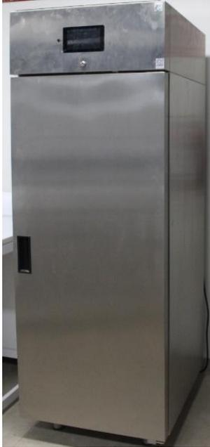
Refrigerador de laboratorio útil para el almacenamiento de reactivos y muestras que deban conservarse a temperaturas bajas. Rango de temperatura: 0 a 15 °C. Capacidad de 625 L.
