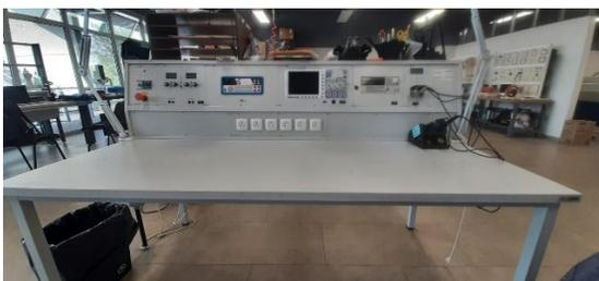
Mesa de trabajo equipada con multímetro, fuente de poder, osciloscopio, generador de funciones y dos cautines. Opera a 120 V, 16 A, 60 Hz, ideal para reparaciones y pruebas electrónicas.
