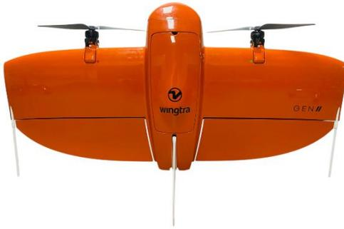
Dron de ala fija VTOL para realizar levantamientos topográficos y cartográficos de alta precisión, cobertura hasta de 110 hectáreas, tiempo máximo de vuelos autónomos de 59 minutos. Uso en la industria geoespacial, minería, construcción, agricultura, forestal, ordenamiento territorial, riesgos geológicos, catastral, entre otros
