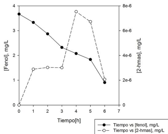
Figura 3. Cinética de oxidación de fenol y de producción de 2-HMAS.
