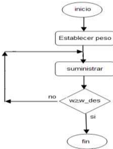
Figura 3. Diagrama de flujo para control de alimentación
