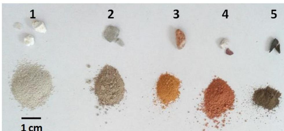
Figura 1 Muestras de arenas de caolín clasificadas por colores, antes y después de ser molidas.
