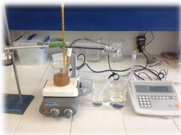
Figura 1. Dispositivo general de síntesis de \text{Tb}_{0.7}\text{Ca}_{0.3}\text{MnO}_3 por el método de coprecipitación química.
