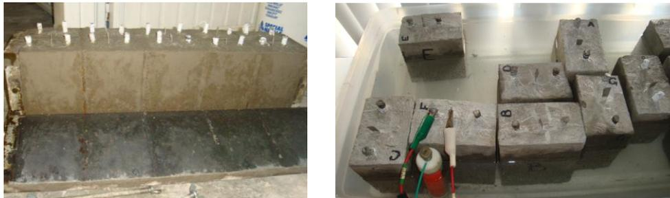
**Figura 4.** Descimbrado y etapa de curado de especímenes de prueba.
