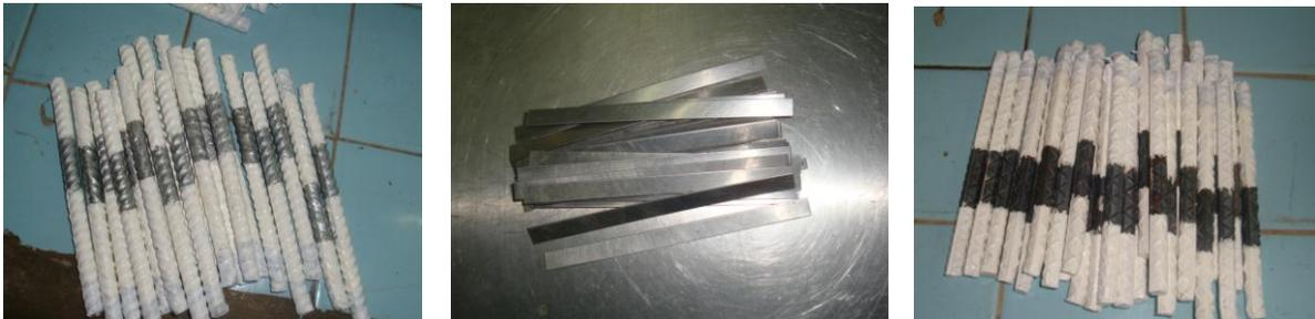
**Figura 2.** Preparación del acero utilizado como refuerzo.
