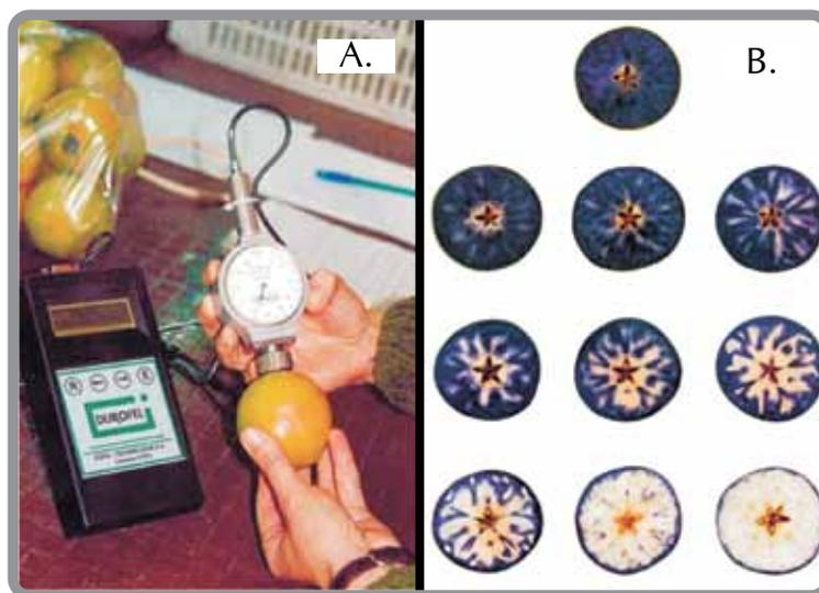
**Figura 17.** a) Medición de la firmeza de un fruto mediante métodos objetivos. b) La inmersión en una solución de yodo indica la desaparición del almidón (color oscuro) a medida que la manzana madura.
