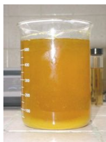
Figura 5. Precipitación de (\text{NH}_4)_2(\text{PtCl}_6) , tras la adición de cloruro de amonio al licor primario.
