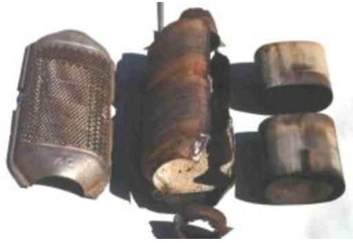
Figura 1. Aspecto físico de un convertidor catalítico automotriz abierto por esmerilado de las uniones. Aparece la cubierta disipadora al lado izquierdo, el cuerpo metálico del convertidor abierto y al lado derecho dos monolitos cerámicos liberados.
