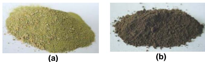
Figura 7. Cristales lavados y desecados de (a) Platino y (b) Rodio
