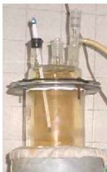
Figura 3. Fotografía del digestor de vidrio en operación.
