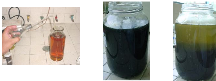
Figura 6. Burbujeo de \text{H}_2\text{S} sobre el licor terciario y formación del precipitado de rodio
