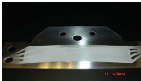
Finalmente estudios realizados por MEB de los productos de reducción retirados mecánicamente de la superficie del acero inoxidable A304 verifican que la recuperación obtenida de las placas radiográficas es plata.
