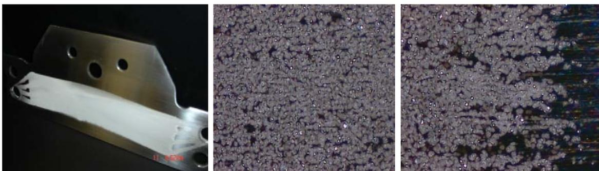
**Figura 2.** Recubrimiento obtenido sobre Acero Inoxidable después de realizar una cronopotenciometria a una corriente de -50mA durante 120 minutos.
