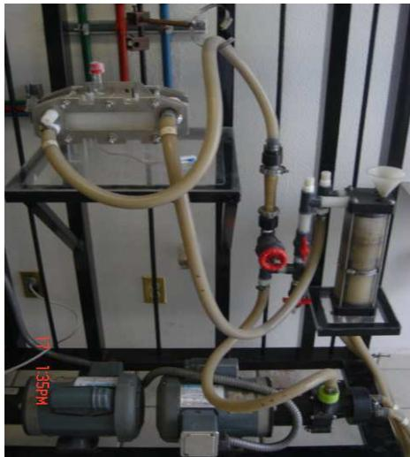
**Figura 1. Sistema hidráulico: recipientes bombas y puertos de muestreo utilizados en la realización de macroelectrólisis.**
