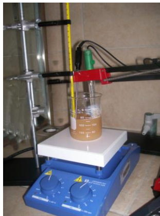
Figura 1. Dispositivo general de síntesis por el método de co-precipitación química.
