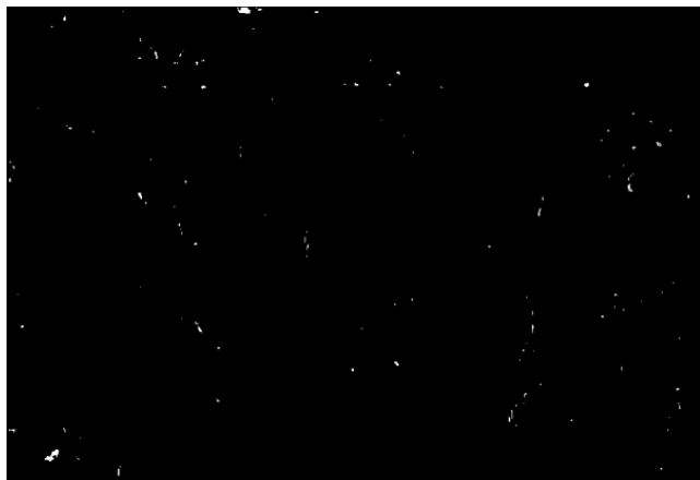
Figura 8. Procesamiento de la microfotografía de la muestra tomada desde el interior de la tubería de acero al carbono SAE 1018 en buen estado (invertida)
