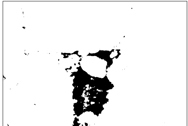
Figura 6. Procesamiento de la microfotografía de la muestra 2 tomada al interior de la tubería de acero al carbono SAE 1018 con daño en la superficie.
