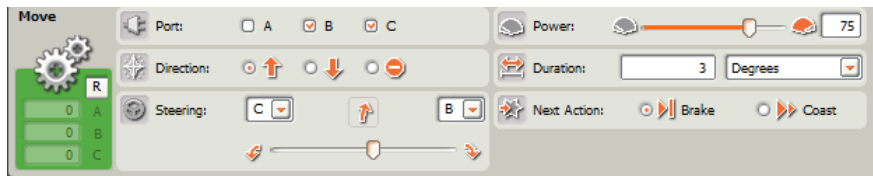
Ilustración 28. Configuración de la acción move en caso de captar mucha luz. (Fuente propia).
