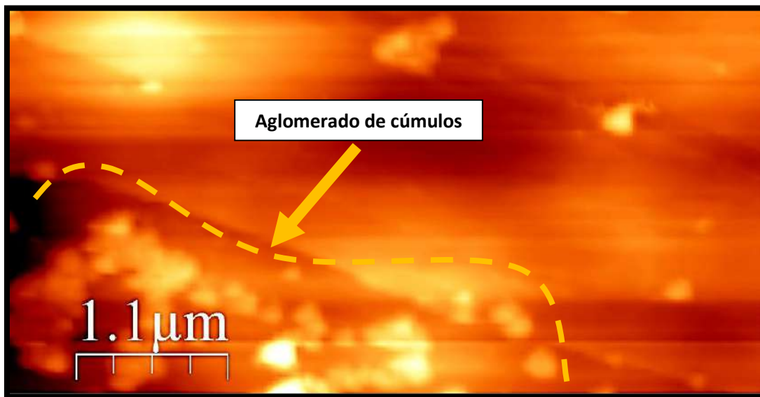
Figura 4.121 Acercamiento a una región de la muestra mediante AFM a una escala de 1.1 μm del sistema HOPG/0.001 M PdCl 2 + 1 M NH 4 Cl pH=8. Temperatura 40°C.
