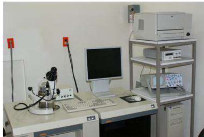
Figura 3.7 Microscopio Electrónico de Fuerza Atómica y de Tunelamiento JSPM-4210. Ubicado en el Instituto de Física UNAM.
