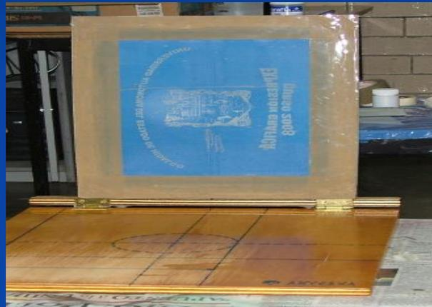
**Emulsión:-** Es un líquido obtenido de una mezcla de dos sustancias químicas llamados séricrom 10 milímetros y bicromato un centímetro. Mezclándolos vienen un recipiente obscuro para que no pierdan su fuerza y dureza al mezclar las sustancias.
