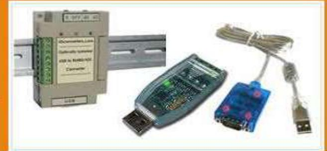
Comunicación computadora - máquina (RS232, Ethernet, USB)
