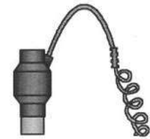
ADAPTADOR DE TIERRA, CONECTADO A LA MALLA DEL CABLE DE ENERGÍA
