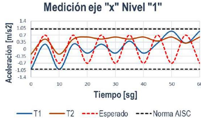
**Figura 13.** Simulación del comportamiento cíclico de la aceleración eje "x" Nivel 1
