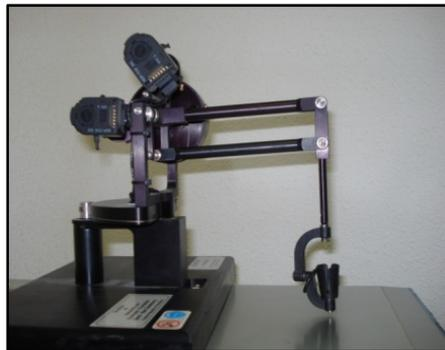
Figura 2.-Dispositivo háptico PHANToM 1.0
