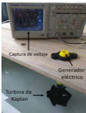
Figura 8: Registro del voltaje mediante osciloscopio.
