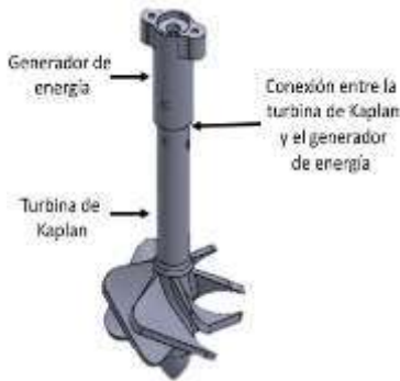
Figura 3: Sistema de acoplamiento eléctrico.
