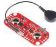
Figura 6: Sensor electromiográfico Myoware™.
