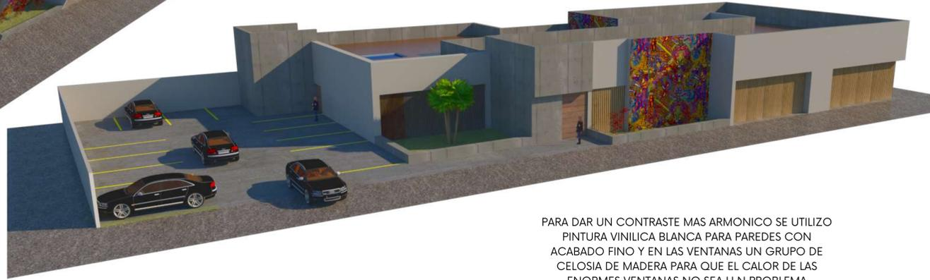
PARA DAR UN CONTRASTE MAS ARMONICO SE UTILIZO PINTURA VINILICA BLANCA PARA PAREDES CON ACABADO FINO Y EN LAS VENTANAS UN GRUPO DE CELOSIA DE MADERA PARA QUE EL CALOR DE LAS ENORMES VENTANAS NO SEA UN PROBLEMA
