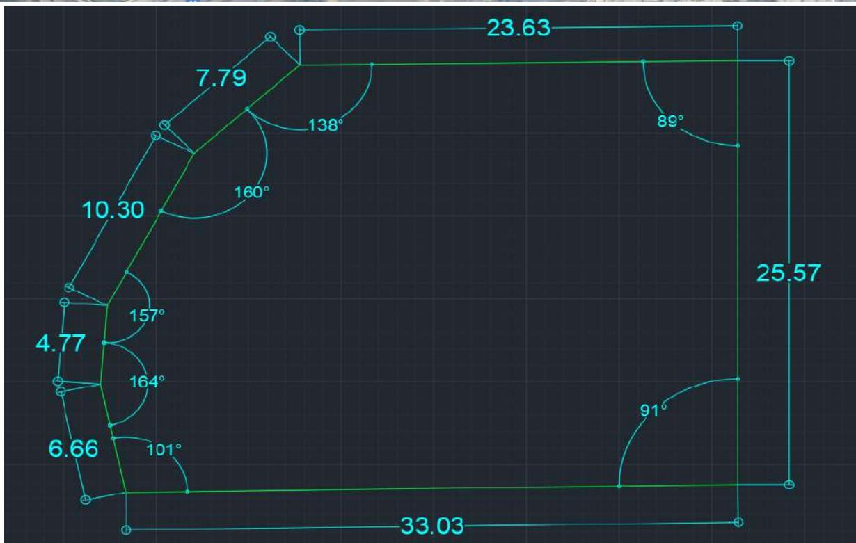
Imagen 2. Dimensiones del predio elaboradas en Autocad
