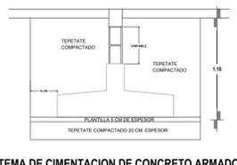
SISTEMA DE CIMENTACION DE CONCRETO ARMADO
