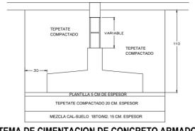
**SISTEMA DE CIMENTACION DE CONCRETO ARMADO**
