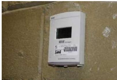
Data logger, revisión de temperatura y humedad
